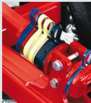
Klipsy dystansowe różnych kolorów i grubości są łatwe do zmiany i używane do regulowania głębokości pracy
