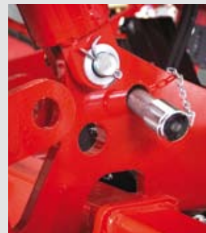
Duże sworznie bezpiecznie blokują Terrano 8FX w pozycji transportowej
