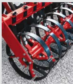
Wał Rollflex dla głębszego zagęszczenia i rozluźnienia powierzchni
