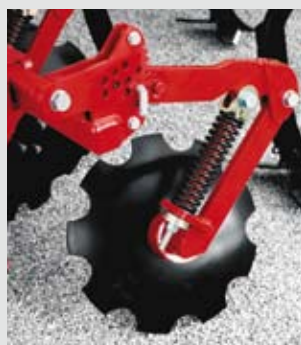
Indywidualnie montowane talerze wyrównujące z zabezpieczeniami przeciw kamieniom z przodu wału
