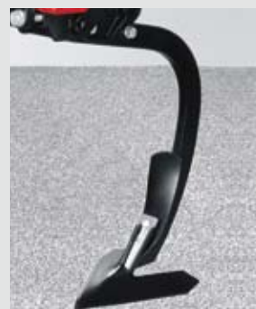
Gęsiostopy są wymieniane szybko i łatwo przy użyciu młotka. Po nabiciu na ząb zabezpieczają się zamkiem
