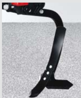
Zęby MulchMix podcinają glebę, intensywnie ją mieszają i równomiernie rozrzucają
