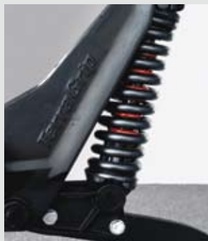
Dwie masywne sprężyny pozwalają na precyzyjne utrzymanie głębokości roboczej
