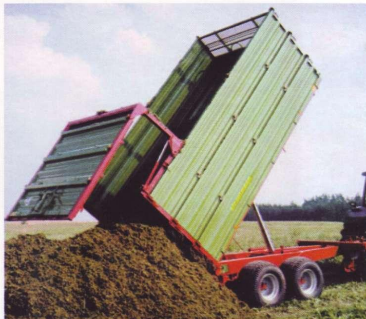
Wywrotka tandemowa z nadstawką do kiszonki, o wysokości ściany skrzyni 1,5 m lub 1,8 m
