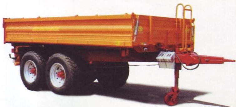
Wywrotka tandemowa z nadstawką do kiszonki, o wysokości ściany skrzyni 1,5 m lub 1,8 m
